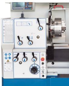
*Les nombreuses fonctions de l'affichage de position X.Pos sont ici complétées par l'affichage numérique de la vitesse de rotation et une fonction supplémentaire facilement programmable*
