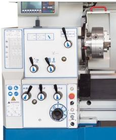
Las amplias prestaciones del indicador de posición X.Pos se complementan con un indicador digital de velocidad y una función auxiliar fácil de programar
