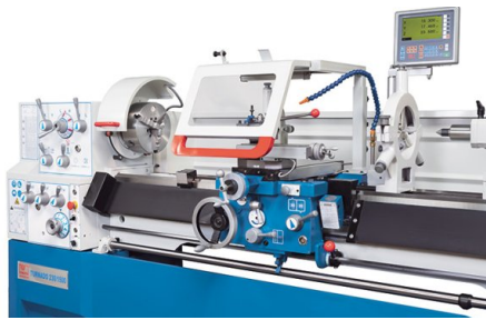
Le grand carter de protection pivotant situé sur le support protège l'utilisateur et préserve la propreté de la zone de travail
