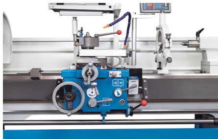
L'accouplement à friction pour l'avance automatique se situe au centre du tablier et se règle facilement
