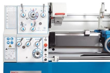
**Удобная панель управления на передней бабке помогает быстро освоить станок и управлять его работой интуитивно**
