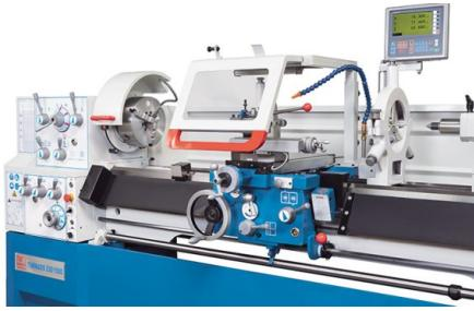
**Большой поворотный защитный кожух на суппорте защищает оператора и помогает поддерживать чистоту в рабочей зоне**
