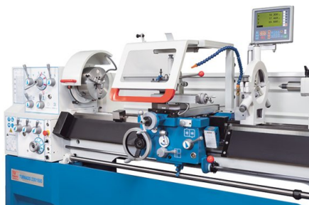
Duża przechylna osłona ochronna na wsporniku chroni operatora i utrzymuje obszar roboczy w czystości
