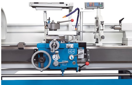
Sprzęgło poślizgowe automatycznego posuwu jest umieszczone centralnie na kasecie zamka i można je łatwo regulować
