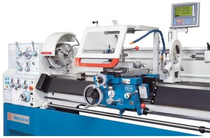
La gran cubierta de seguridad giratoria en el soporte protege al usuario y mantiene limpio el espacio de trabajo
