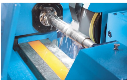
Плавная и очень точная регулировка гидравлического механизма продольной подачи
