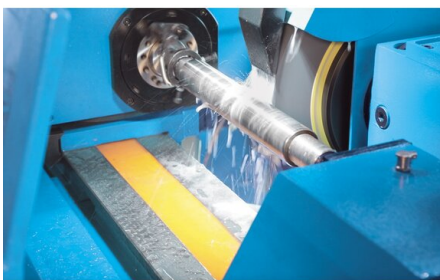
Der hydraulische Längsvorschub ist stufenlos und sehr feinfühlig einstellbar
