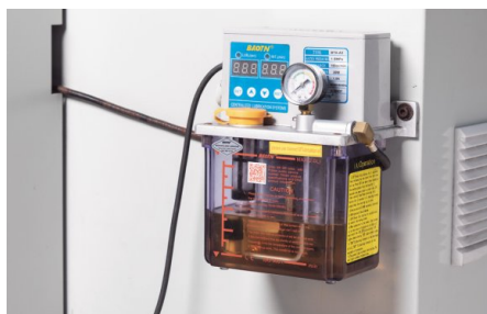
Lubrifierea continuă și precisă minimizează frecarea și uzura pieselor mobile și crește durata de viață a mașinii
