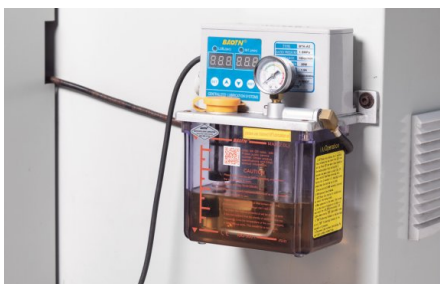
Kontinuierliche und präzise Schmierung minimiert Reibung und Verschleiß beweglicher Teile und erhöht die Lebensdauer der Maschine
