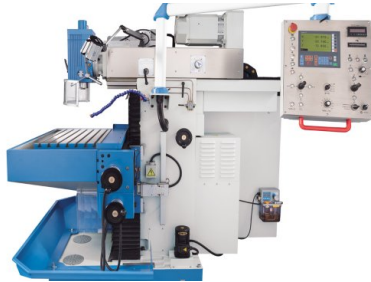
Die konzentrierte Anordnung der Bedienelemente sorgt für eine übersichtliche und intuitive Bedienung
