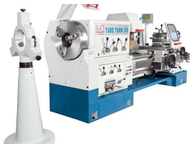
L'autocentrante posteriore conferisce stabilità per la lavorazione di pezzi lunghi
