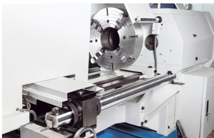
Dispositivo per tornitura conica incluso nella dotazione standard
