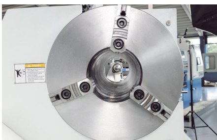
Passage de broche jusqu'à 225 mm
