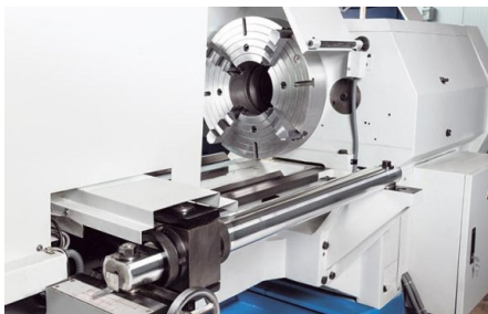
Dispositif de tournage conique de série
