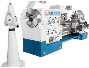
Das rückseitige Drehfutter gibt langen Werkstücken Stabilität
