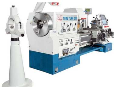
Tylny uchwyt tokarski zapewnia stabilność długim obrabianym elementom
