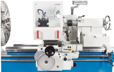
Eilgang für X- und Z-Achse ermöglichen schnelle Positionierung des Supports und verringert Nebenzeiten
