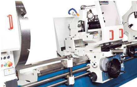
Los apoyos rígidos se incluyen en el equipamiento estándar de la máquina
