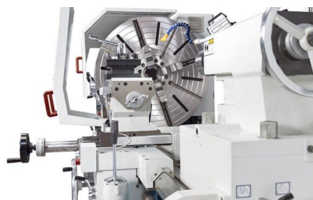
Le support et la coulisse supérieure sont conçus pour des forces de coupe importantes
