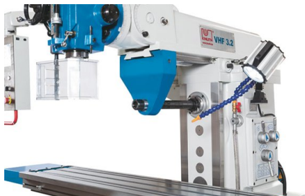
Guidages rectifiés avec précision, à la surface trempée, grande zone de travail précise, résistante et durable
