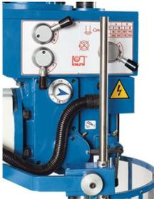
Avanzamento cannotto automatico con 3 livelli di velocità
