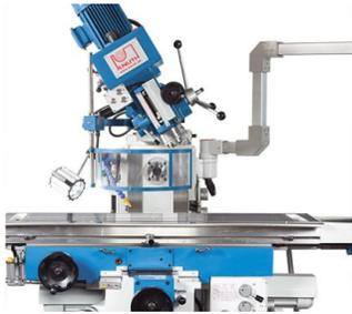
Testa di fresatura orientabile a  $\pm 45^\circ$
