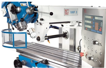
Ax de frezare orizontal cu suport exterior pentru mandrine de frezat piese lungi
