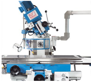
Tête de fraisage pivotable \pm 45^\circ
