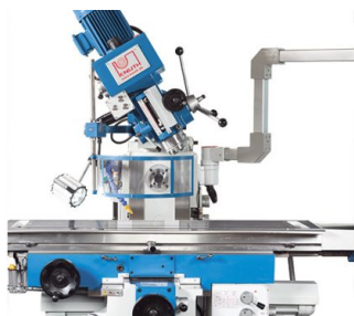
Výkyvná frézovací hlava \pm 45^\circ
