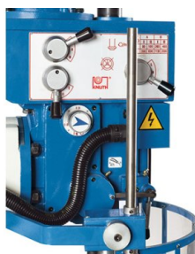
Automatický posuv pinoly se 3 stupni
