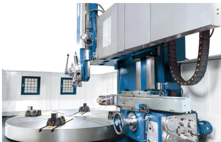
Вертикальный суппорт с 5-разъемной оправкой для инструмента и боковым суппортом с собственной подачей для внутренней и внешней обработки
