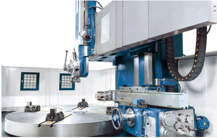
Support vertical avec porte-outils quintuple et support latéral avec avance séparée pour usinages intérieur et extérieur
