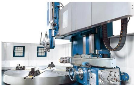
*El soporte vertical incluye un soporte para herramientas de 5 estaciones, soporte lateral con alimentación independiente para giros en el interior y exterior*
