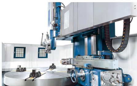
Il carrello verticale con torretta portautensili a 5 posizioni e slitte laterali con avanzamento proprio per lavorazione interna ed esterna
