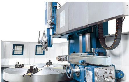
Vertikaler Support mit 5-fach Werkzeughalter und Seitensupport mit eigenem Vorschub für Innen- und Außenbearbeitung
