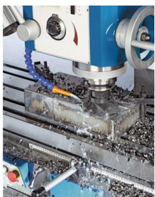
Frezare plana, cu cap de masurare
