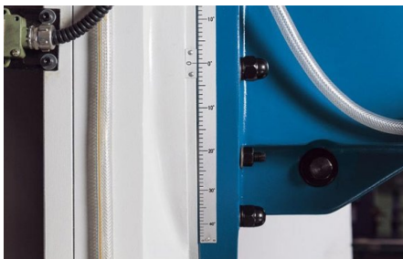
La tête de fraisage très stable peut pivoter et s'aligner de manière précise
