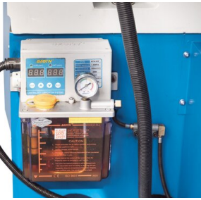
Die Zentralschmierung versorgt alle Schmierstellen zuverlässig mit Schmierstoff und erleichtert so die tägliche Wartung
