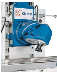
Ve 2 rovinách lze nastavit do každého úhlu
