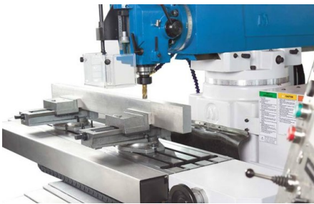
Precizie datorita suruburilor cu bila
