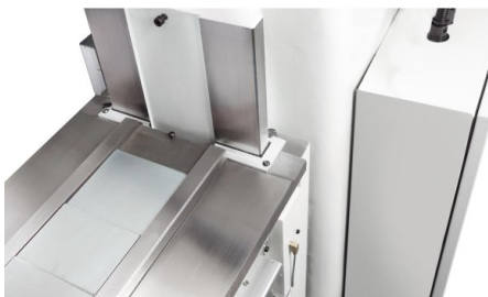
Guide piane ampie e molto stabili sugli assi Z e Y
