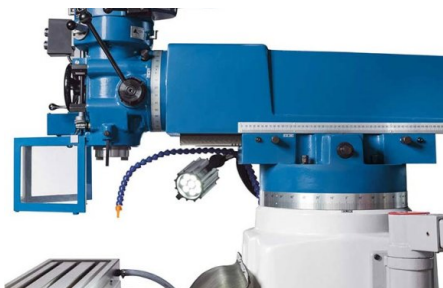
Регулируемые вылет и угол обработки
