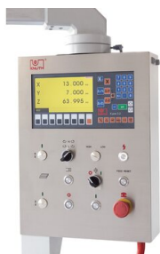
Положение интуитивно понятной панели управления регулируется с помощью консоли
