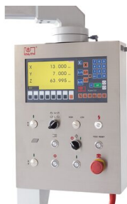
Le panneau de commande intuitif peut être positionné selon le besoin grâce au support
