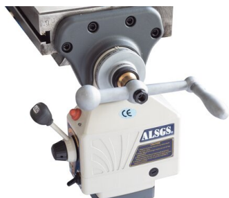
Les axes X et Y disposent d'une avance automatique et d'un déplacement rapide
