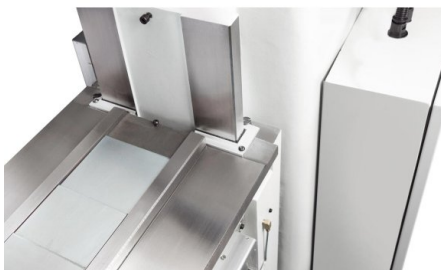
Guidages plats larges et stables dans l'axe Z et X
