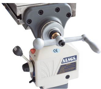
Osy X a Y mají automatický posuv a rychloposuv
