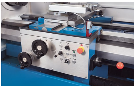
Commande par manivelles électroniques dans la plage \mu\text{m} – toucher et position comme sur une machine conventionnelle
