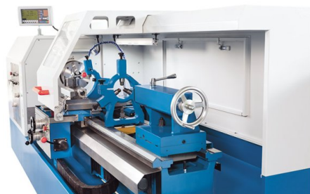
Commande par manivelles électroniques dans la plage \mu\text{m} – toucher et position comme sur une machine conventionnelle
