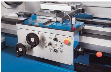
*Microcontrol a través de ruedas manuales electrónicas - pero la manipulación y el posicionamiento son iguales a los de una máquina convencional*
