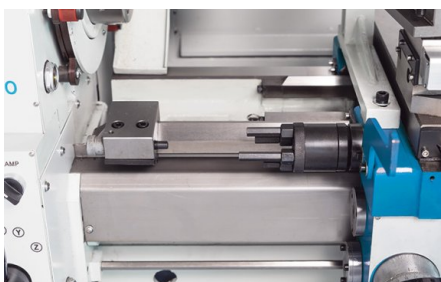
Il sistema di lubrificazione centralizzata integrato nel carrello garantisce facilità di manutenzione e semplicità d'uso
