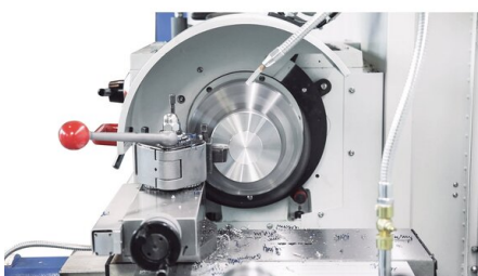
Постоянная скорость реза: при торцевом точении частота вращения шпинделя автоматически подстраивается под меняющийся диаметр заготовки
