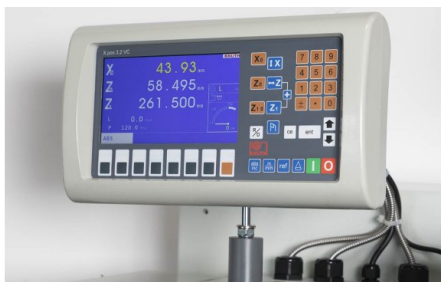
Постоянная скорость реза: при торцевом точении частота вращения шпинделя автоматически подстраивается под меняющийся диаметр заготовки
