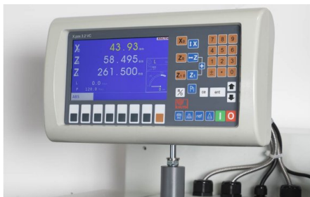
V-constant - turația arborelui este adaptată automat la schimbarea diametrului piesei de prelucrat în timpul strunjirii frontale
