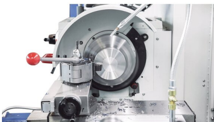
V-constant - turația arborelui este adaptată automat la schimbarea diametrului piesei de prelucrat în timpul strunjirii frontale
