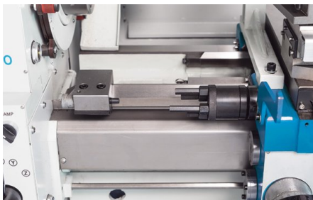
Ungerea centralizata este integrata in suport ceea ce usureaza mentenanta si operarea
