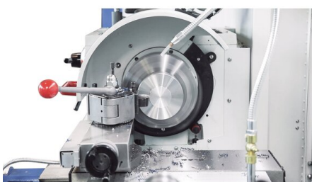
Constante V : la vitesse de broche est automatiquement adaptée au changement de diamètre de pièce lors du surfacage
