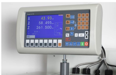
Constante V : la vitesse de broche est automatiquement adaptée au changement de diamètre de pièce lors du surfacage
