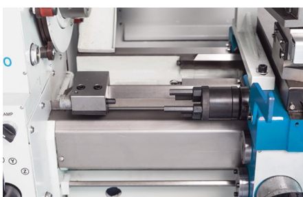
Snadnou údržbu a jednoduchou manipulaci zaručuje centrální mazání integrované v suportu
