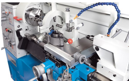
Высококачественный быстроменяемый стальной держатель с точностью позиционирования 0,01 мм
