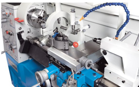
Hochwertiger Schnellwechselstahlhalter mit einer Wiederholgenauigkeit von 0,01 mm
