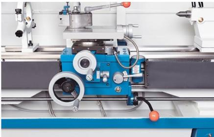
*L'arresto micrometrico del bancale garantisce la precisione di ripetibilità*
