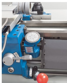
Ceasul de filetare permite reluarea filetului după ce maneta de blocare a fost deblocată pentru mișcarea de retur
