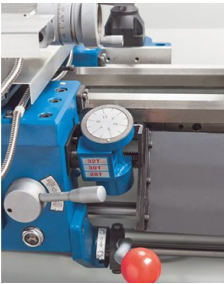
El calibrador de roscas permite reanudar la rosca después de que la tuerca de la placa frontal se ha abierto
