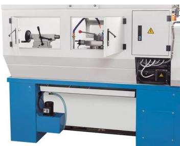
*La zone de travail est également accessible depuis l'arrière de la machine grâce à de grandes trappes*
