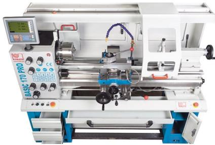
*Le soubassement de la machine offre beaucoup d'espace de rangement pour les outils et les accessoires ainsi qu'un bac à copeaux qui se retire par l'avant*
