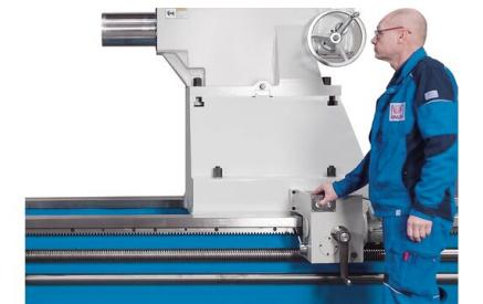
*La contre-pointe peut être positionnée par moteur (tous les modèles à partir de 3 000 mm d'entrepointes)*
